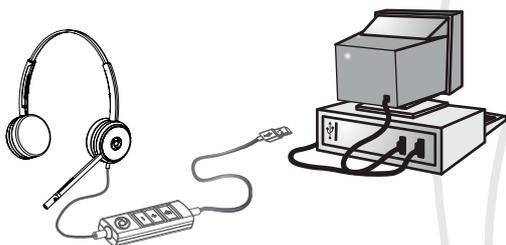
O Bravo USB não necessita de instalação de software ou drivers adicionais. Conectar a ponta do cabo USB em uma das saídas USB do PC. O sistema reconhecerá a conexão do seu headset e a partir desse momento, todas as funções multimídia poderão ser realizadas pelo headset.
