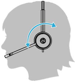
Para colocar el micrófono en el lado derecho o izquierdo, gire la puntera hacia arriba. Coloque la puntera de manera que esté orientado hacia su boca.
