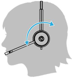
Para posicionar o microfone do lado direito ou esquerdo, gire a haste para cima. Posicione a haste para que ela fique direcionada para a boca.
