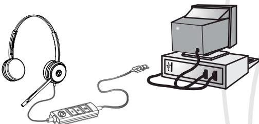
El Bravo USB no requiere la instalación de software o controladores adicionales. Conecte el cable USB en uno de los puertos USB del PC. El sistema reconocerá la conexión de su headset y a partir de ese momento, todas las funciones multimedia serán realizadas por el headset.
